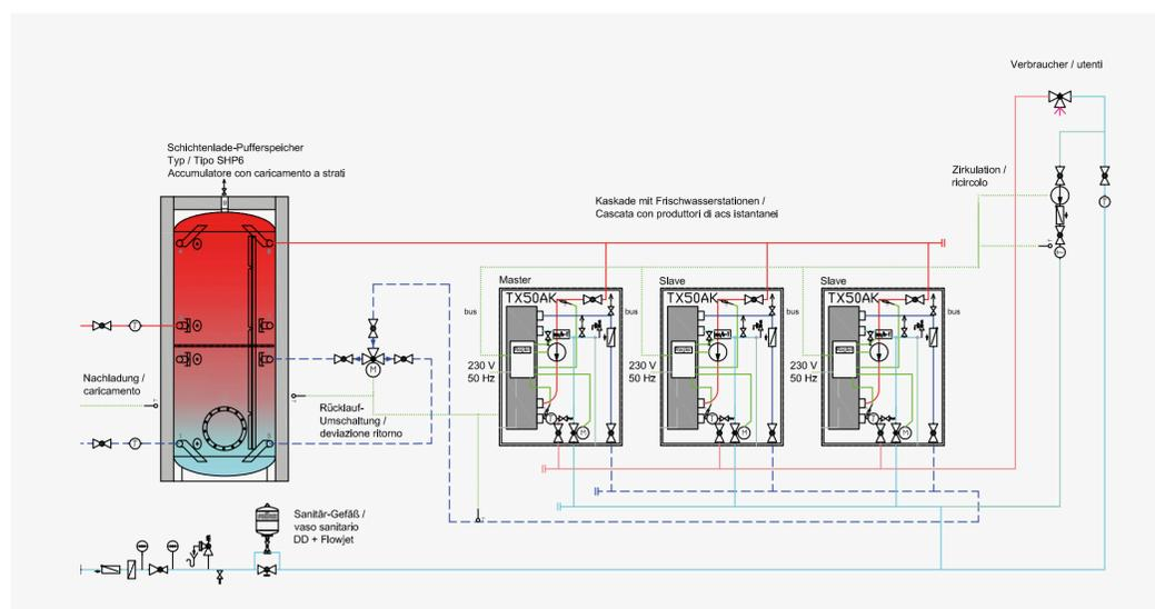
Le regolazioni dei produttori istantanei TX-A sono dotate di una "funzione antilegionella" per la disinfezione termica dei circuiti d'acqua calda e del ricircolo, innalzando la temperatura dell'acqua calda in orari programmabili a livelli tra 60 e 70°C.
